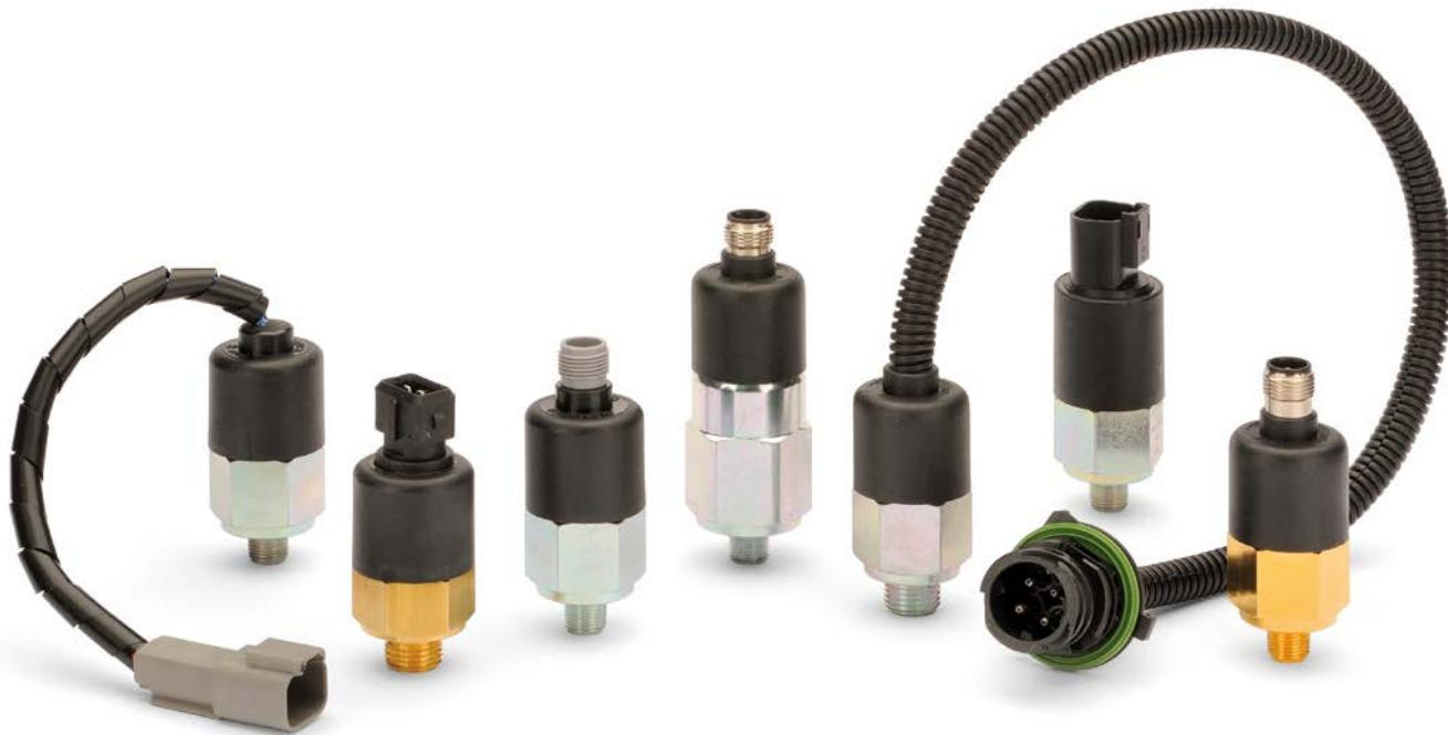
所有应用领域（农机、挖掘机、商用车、液压、过滤等）的安全标准不断提高，因此也提高了对压力开关和压差指示器等部件的要求。连接中的车载电子设备必须能够识别连接电缆中有故障或损坏的连接器、短路和中断。通过在开关中安装电阻器获得诊断能力。电阻器是集成的，因此开关保持符合所需的 IP 等级，不需要额外空间增加诊断能力。
