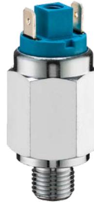
**P700**该温度压力开关由具有 NO 或 NC 触点的可调膜片式压力开关和内置固定设置的双金属恒温器组成，其触点与压力开关的触点相连。NC 触点并联，NO 触点串联。
